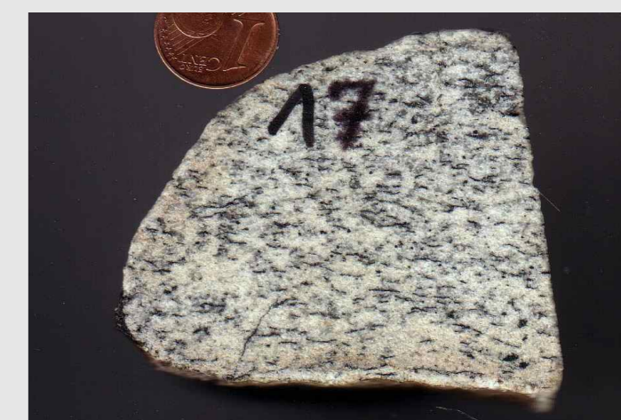
Anschnitt eines Quarz-Feldspat-Gerölls, das aussen mit einer dünnen Glashaut überzogen ist. Während die hellen Quarze überlebt haben, sind die Feldspäte weitgehend zu einem Glas umgewandelt, das partiellweise dunkel gefärbt ist und das faserige Gefüge erzeugt.
