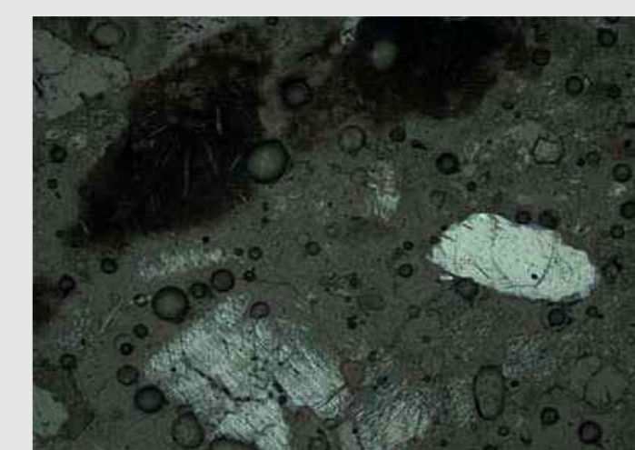
Dünnschliffaufnahme des Gerölls: Graue Feldspäte werden vom Glas (graubraun) verdrängt. Es treten nadelige Rekristallite und viele Gasblasen auf. Bildbreite ca. 0,5 mm.
