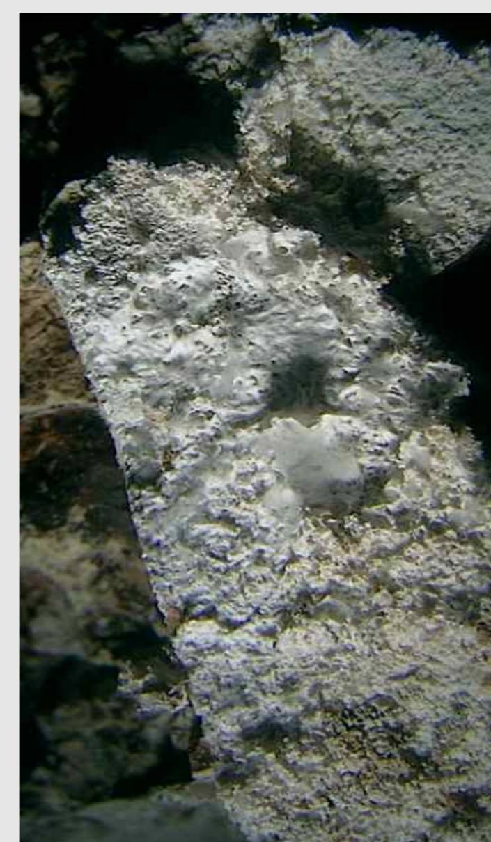
Aufgebrochener Kalksteinbrocken aus Krater 004 mit kristallisierter Karbonatschmelze in Form blasiger Tapeten und watteähnlicher Aggregate. Bildhöhe 3 cm.
